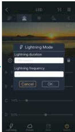
Geben Sie die Dauer zwischen 1-99 Minuten ein. Geben Sie die Frequenz zwischen 1-8 ein. Wählen Sie OK zur Bestätigung.
