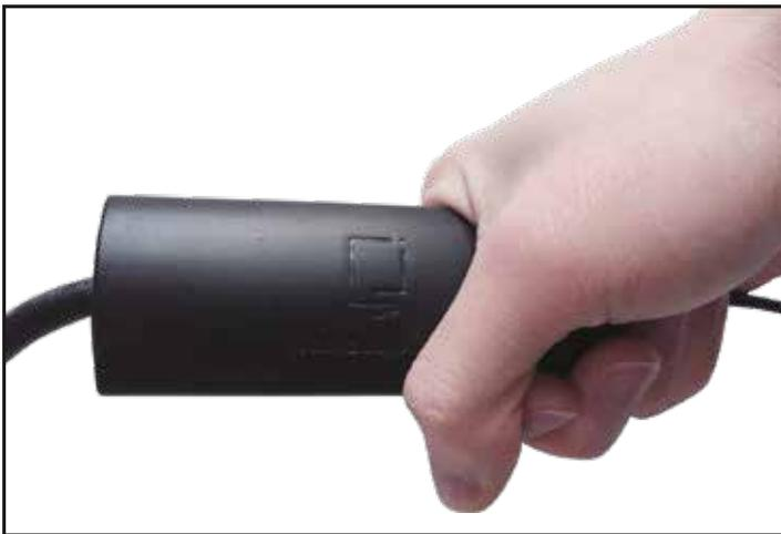
Halten Sie den WiFi-Controller für 10 Sekunden, wie im Bild unten gezeigt. Sobald das Licht blinkt, ist der Reset erfolgreich abgeschlossen.
