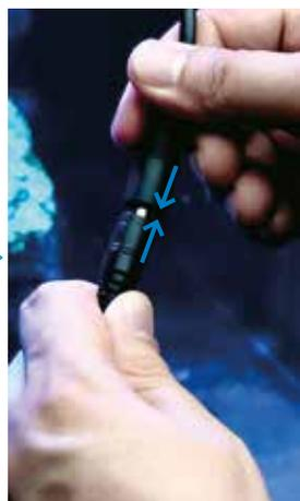
Maintenant, connectez-le ou les éclairages(s) en branchant l'alimentation (un par un). L'éclairage clignote 8 fois lorsqu'il est connecté avec succès.
