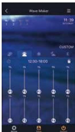
Déplacez le curseur pour définir la puissance et la fréquence respectives pour les 5 blocs. Les blocs sont indiqués de D1 à D5. (P1 et F1 représentent la puissance et la fréquence pour D1, et ainsi de suite)
