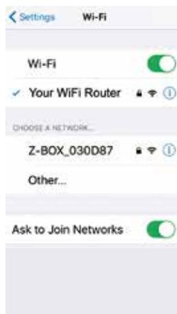
L'appareil mobile est connecté au routeur. Le control box peut être contrôlé via le routeur (le voyant de fonctionnement du Control box sera bleu lorsqu'il sera connecté au routeur avec succès).
